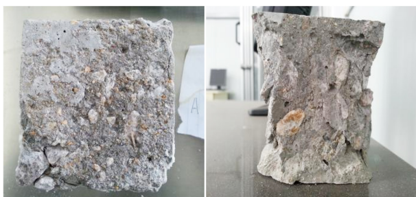
图 1 试块的冻融和抗压破坏
