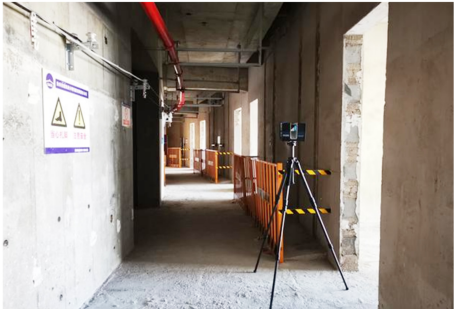
图 1 三维激光扫描仪实测现场
