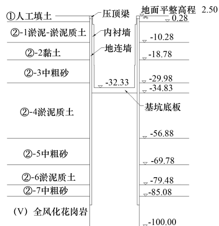
图 1 地层剖面及地连墙支护结构 m
