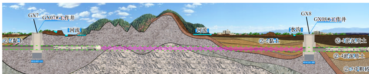
图 7 GX7~GX8 盾构隧洞地质剖面
