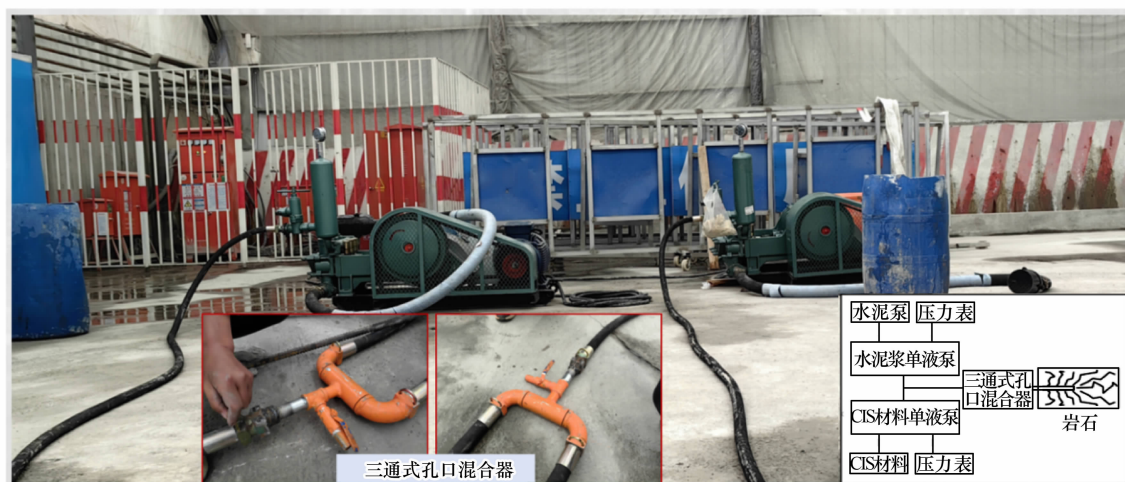
图 8 三通孔口混合器高效双液注浆泵
