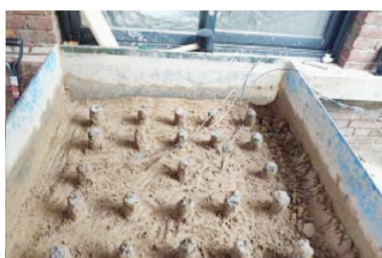
图 11 试验结束后挖桩
