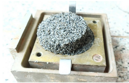
图 8 反复直剪作用下 26.324% (饱和) 含水率尾砂直剪破坏
